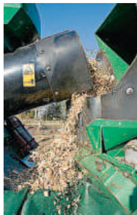
LAGER FLIS. Flismaskinen plukker opp alt løst trevirke, mater det inn foran og ut kommer flis.
